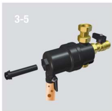
Демонтаж магнита (поверните на 90° по часовой стрелке)
