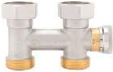
Байпас первичного контура (опция) обеспечивает гидравлическое разделение между первичным и вторичным контурами. Такое гидравлическое разделение оптимизирует работу вторичного контура и препятствует влиянию изменений расхода первичного контура на вторичный контур. Поток, проходящий через соответствующие контуры, зависит исключительно от показателей расхода насосов, что позволяет избежать взаимного влияния, вызванного их последовательным соединением.
